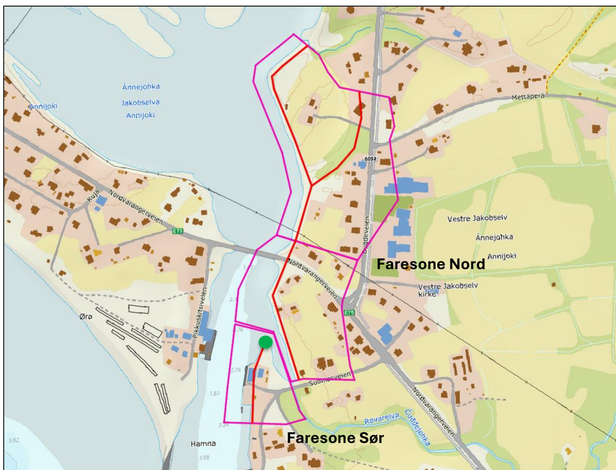
Figur 6-7: Avgrenset løsneområder for et retrogressivt skred hvor L = 15H merket med rosa linjer. Kritiske skråninger er markert med røde linjer. Bp. 26-T33, som påviser ikke sprøbruddmateriale og danner grunnlaget for deling av løsneområdet i to, er markert med et grønt punkt.
