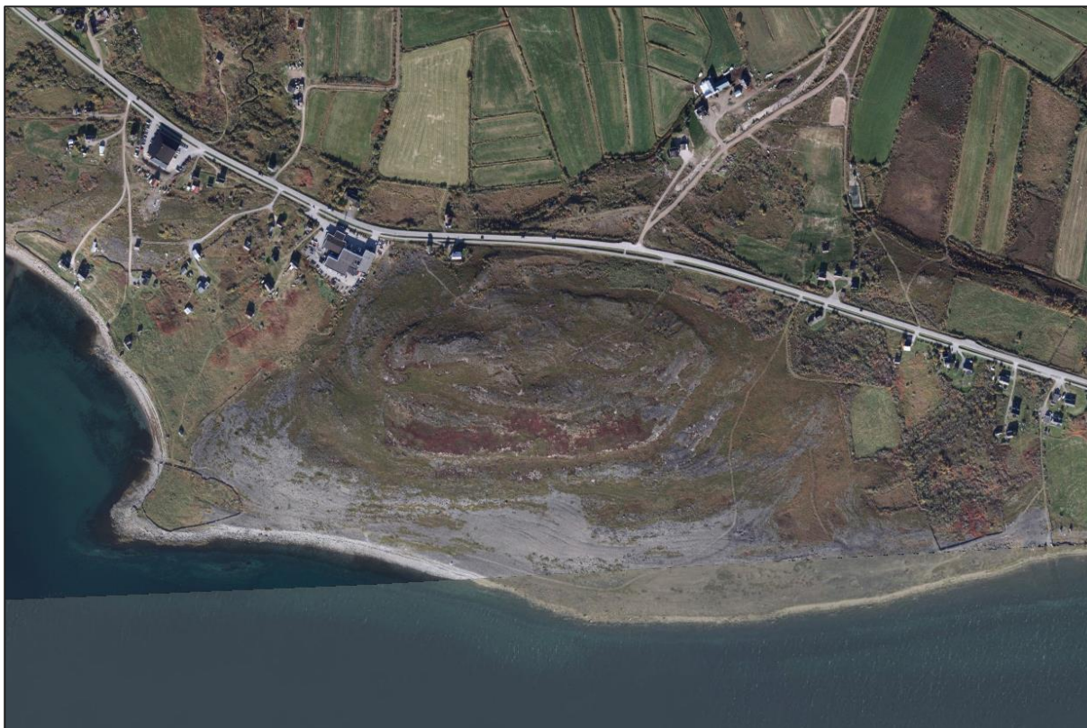
Figur 6-6 Flyfoto over Torvhaugen (sørøst fra det aktuelle området) fra 2014 [norgebilder.no]. Det vurderes å være berg i dagen delvis dekket med tynt lag av løsmasser.
